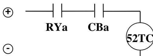
高壓斷路器(H.V.CB) 或特高壓 CGIS 或 GIS，是接受保護電驛(Relay)a 接點的指令，跳脫高壓斷路器，將事故源隔離。高壓斷路器能否及時跳脫，受控於保護電驛(Relay)是否能即時發出指令。因此，保護電驛的工作電源是否正常就是一個非常重要的課題，當提供保護電驛的工作電源喪失或能量不足時，該保護電驛就不會動作；該保護電驛不會動作時，高壓 CB 在事故發生時也就不動作，無法將事業單位的事故點隔離，則擴大造成更嚴重的二次事故，甚至影響台電饋線跳脫！實不可不慎。
